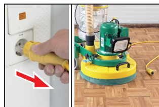
Abb. 9 Den Netzstecker aus der Steckdose ziehen: → Die Arbeitsleuchte geht aus.
