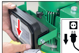
Abb. 3 Die Arbeitsleuchte nach unten schieben.
