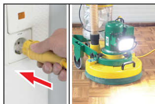
Abb. 8 Den Netzstecker in die Steckdose einstecken: → Die Arbeitsleuchte leuchtet.
