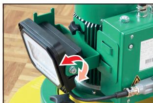
Abb. 10 Die Arbeitsleuchte kann nach oben und unten geschwenkt werden.
